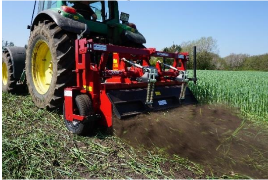
Figur 2: Rath geohobel. Overfladefræsning af vinterrug med og uden overfladekompostering.
