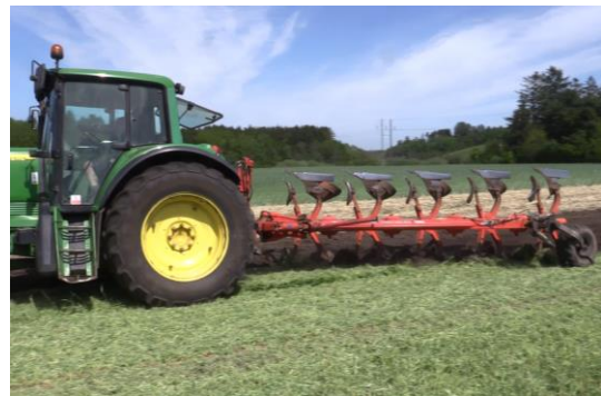
Figur 5: Skrælpøjning. Overfladisk pløjning og ingen yderligere såbedsforberedelse.
